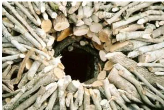
Si può dar fuoco, ciò avviene portando una fiamma attraverso il foro centrale. Inizia così la combustione lenta, in mancanza di ossigeno la legna si trasformerà in carbone. Il cumulo ha l'aspetto di una capanna ma il lavoro non è terminato: il carbonaio aiutato da tanti altri pratica dei fori con un bastone appuntito in tutta la circonferenza del cumulo sino a penetrare nella legna. Dai fori inizierà a fuoriuscire fumo che durerà per vari giorni, ed è il segnale che tutto procede bene. La Kea
