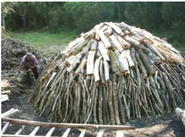
Il carbone prodotto dalla combustione avrà un potere calorifero maggiore o minore a seconda del tipo di legna usata e dal grado di umidità creata all'interno.
